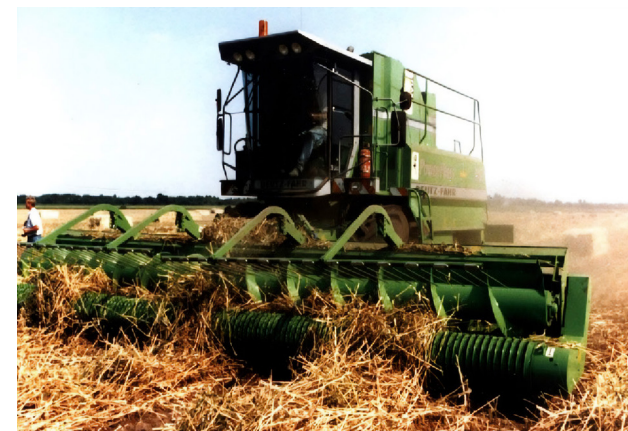
Figura 3 – Uma colheitadeira John Deere Kemper, com tambores circulares que cortam os caules de cânhamo, mostrada em operação no sul de Ontário.
