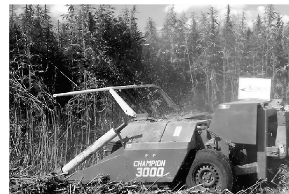
Figura 4 – Uma colheitadeira de cânhamo operada pela HempFlax (Holanda), com uma cabeça de corte larga capaz de cortar caules de 3 metros em pedaços de 0,6 metros, com capacidade de 3 ha/hora.
