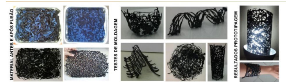
Figura 1: Imagens dos processos de fusão, moldagem e prototipagem
