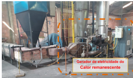
Figura 5: Gerador de Energia Elétrica, a partir do calor remanescente pós combustão dos gases
